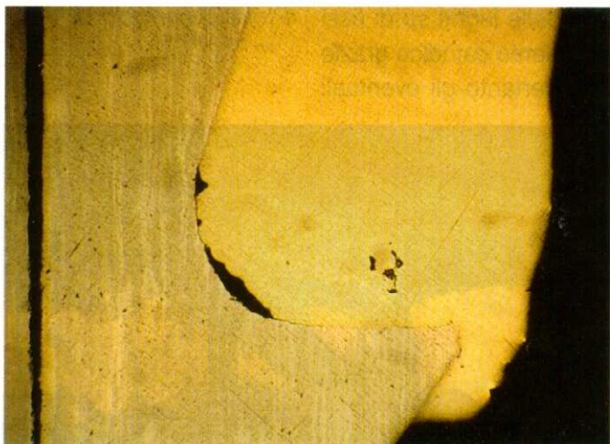
Foto 8 Limitata zona di discontinuità interna in una sovrافusione.
